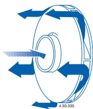
Diffuseur à flux longitudinal-périphérique, pour un **autoamorçage plus rapide**.
